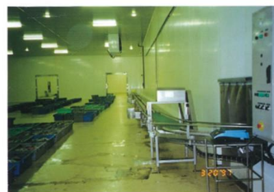
保管エリア：せり販売室から出てきた魚箱を保管エリアに運ぶコンベア
