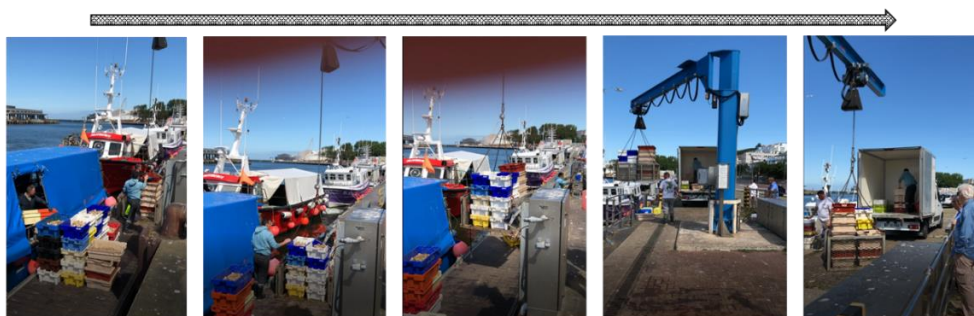
浮体式係船岸に一旦陸揚げし、次に岸壁に固定したホイストを使って陸揚げ
