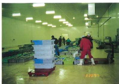
保管エリア：魚箱をせり販売室へ送るため中央左端のコンベアに魚箱を載せる。左上のコンベアはせり販売室から出てきた魚箱を保管エリアに送る。
