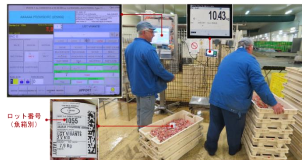
船上で選別・計量されていない水産物については、概ね一定量になるように魚箱に入れ、船名、漁獲水域、漁具・漁法、魚種、規格、品質等の情報を計量計のパネルに入力し、漁獲情報と計量結果を含めて印刷出力したラベルを魚箱に投函 選別・計量エリアは10℃程度に管理
