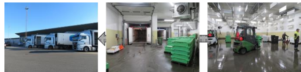
魚箱に投函された名札紙を確認して、バイヤーごとにドックに運搬保冷車に積み込み、加工場等へ輸送
