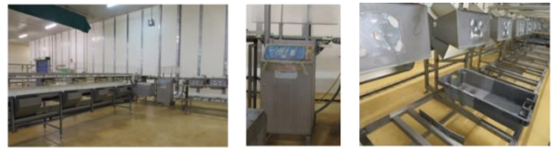
船上で選別・計量されていない水産物については、選別台で手作業で選別または自動選別機で選別自動選別機（1994年の移転時に導入）
