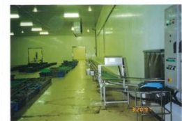
保管エリア：せり販売室から出てきた魚箱を保管エリアに運ぶコンベア
