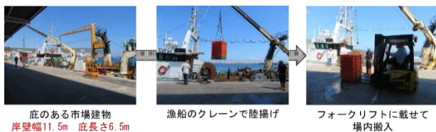
図 1.2.4 陸揚げ・場内搬入
