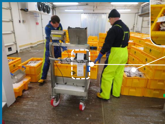
計量結果はPCへ転送と同時にプリンターで出力印刷し、魚箱に投函
