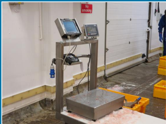
台秤にタブレットとプリンターを搭載 (取外式)
