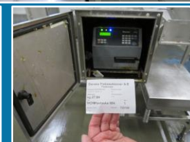
船上で仕分けられていない水産物を手作業または自動選別機で選別し、漁獲・販売情報をラベルに印刷し、箱に投函
