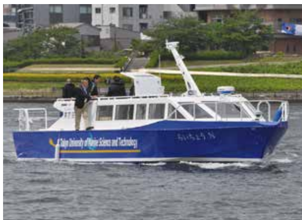
2013年度新造の急速充電対応型電池推進船「らいちょう N」
