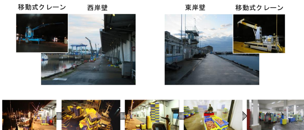
漁船のクレーンで魚箱を陸揚げし、自走式台車に載せて場内搬入
